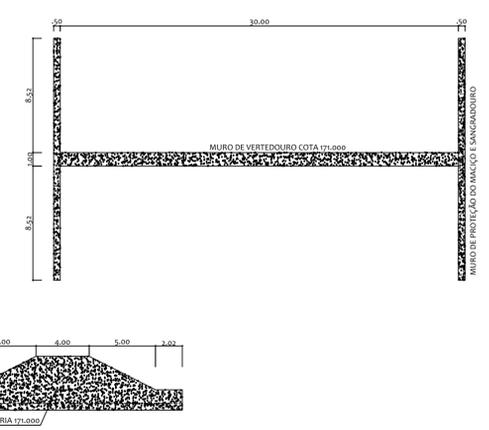
DETALHE DO SANGRADOURO E MURO DE PROTEÇÃO
